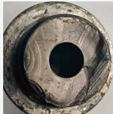
裂纹扩展路径 循环冲击导致疲劳累积
