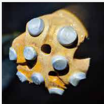
合金齿磨损 持续磨损影响工具寿命
